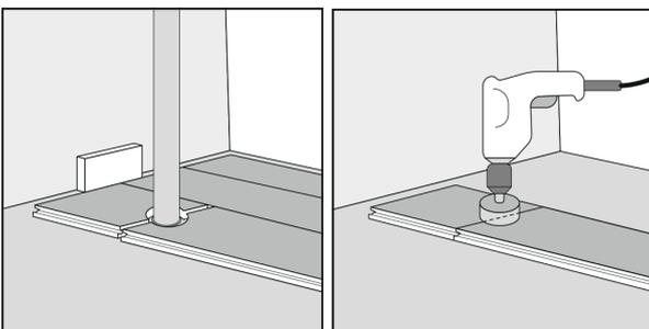
In Reihen, in denen der Bodenbelag auf ein Rohr trifft, ist darauf zu achten, dass das Rohr genau mit den kurzen Seiten von zwei Paneelen fluchtet. Klicken Sie die Paneele an der kurzen Seite zusammen. Bohren Sie mittig auf der Verbindungsstelle zwischen den beiden Paneelen ein Loch mit dem selben Durchmesser wie das Rohr plus 20 mm (3/4").
