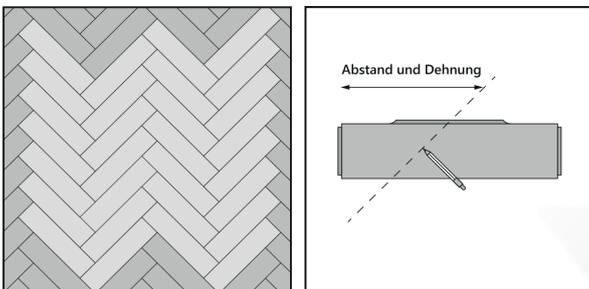
Messen Sie das Randstück wie bereits beschrieben aus. Berücksichtigen Sie die Dehnungsfugen. Zeichnen Sie die Schnittlinie auf Ihrem Paneel an. Verwenden Sie ein Lineal oder eine andere Bodenpaneelle, um eine gerade Linie zu gewährleisten.
