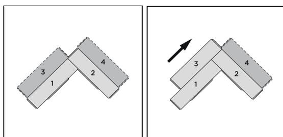
Verwenden Sie eine weitere Ausrichtungspaneele (4), um die Platte 3 auszurichten, indem Sie sie 0,5 cm über die Kante der Platte 2 hinaus anbringen. Winkeln Sie die lange Seite von Paneel 3 in die lange Seite von Paneel 2 in einem Winkel von 20-30° ein, schieben Sie es in Richtung Paneel 4, bis es die Ecke von Paneel 4 erreicht, und winkeln Sie es ab.
