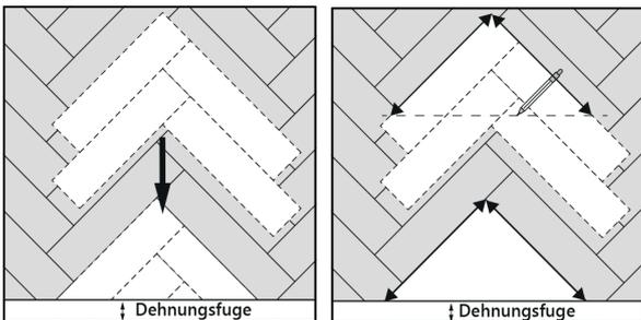
Fertigen Sie die Randstücke mit genügend Paneele an, um die Lücken abzudecken. Messen Sie die Kanten des restlichen Bodens unter Berücksichtigung der Dehnungsfuge aus. Markieren Sie die Maße auf den vorgefertigten Paneelen und schneiden Sie sie zu. Verlegen Sie die restlichen Teile nacheinander. Verwenden Sie bei Bedarf eine Zugeisen.
