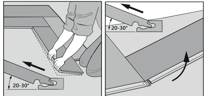
1. Heben Sie die Ecke des Paneels in einem Winkel von etwa 20 – 30° an und bewegen Sie das Paneel vor und zurück, bis es sich löst.
