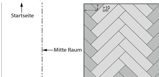
Markieren Sie die Mitte der Startwand, um die V-förmigen Reihen (Fischgrät) auszurichten. Diese Linie unten an der Wand markieren, damit sie während der Arbeit sichtbar bleibt. Planen Sie die Anordnung der V-Reihen so, dass jedes Endstück mindestens 10 cm breit ist. Falls einzelne Stücke zu schmal wären, verschieben Sie die Mittellinie nach links oder rechts.
