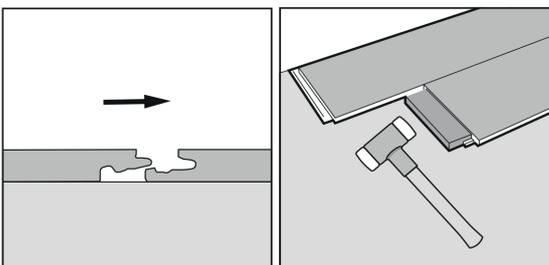
Wenn zwei Seiten verriegelt werden müssen oder das Winkeln nicht möglich ist, verwenden Sie die Klopfmethode. Falls möglich, verriegeln Sie zuerst eine Seite durch Winkeln. Das Klopfen ist an der langen und kurzen Seite möglich. 1. Verwenden Sie einen Schlagklotz und setzen Sie ihn am Verriegelungssystem an. 2. Klopfen Sie vorsichtig mit einem Hammer auf den Klotz, bis sich die Paneele in wenigen Schlägen verbinden.
