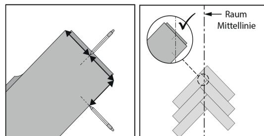
Markieren Sie die Mitte der kurzen Seite des Paneels. Übertragen Sie dieses Maß auf die lange Seite des Paneels und markieren Sie es dort.
