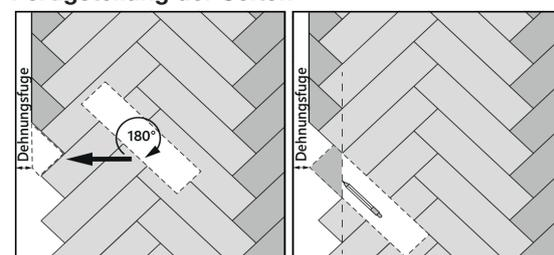
Positionieren Sie die Platte in der richtigen Einbaulage. Drehen Sie das Paneel um 180° und positionieren Sie es dort, wo es eingebaut werden soll.
