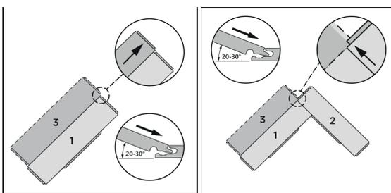
Verwenden Sie eine Ausrichtungspaneele (3), um das Paneel 2 auszurichten, indem Sie es 0,5 cm über die Kante von Paneel 1 hinaus anbringen. Winkeln Sie die lange Seite von Paneel 2 mit der kurzen Seite von Paneel 1 in einem Winkel von 20-30° an, schieben Sie es in Richtung Paneel 3, bis es die Ecke von Paneel 3 erreicht, und neigen Sie es nach unten.
