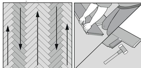
Vervollständigen Sie die erste V-Reihe mit kompletten Paneelen. Achten Sie darauf, dass sie an der Mittellinie ausgerichtet sind. Fahren Sie dann mit den Seiten fort und arbeiten Sie in umgekehrter Richtung. Um die nächste Reihe zu verlegen, verbinden Sie immer die lange Seite der neuen Paneele mit den bereits verlegten Paneelen. Verwenden Sie einen Schlagklotz, um die kurze Seite der Platte zu schließen.
