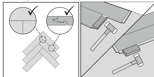
Prüfen Sie nach dem Einbau einer Paneele, ob alle Verbindungen vollständig verbunden sind und keine Lücken oder Höhenunterschiede vorhanden sind. Um sicherzustellen, dass alle Lücken geschlossen sind, klopfen Sie vorsichtig mit einem Hammer auf den Klotz, um die Fugen vollständig zu schließen.
