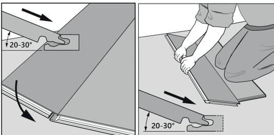
1. Starten Sie mit der Verriegelung der Längsseite. Positionieren Sie das Paneel in einem Winkel von 20–30° zum bereits verlegten Paneel.
